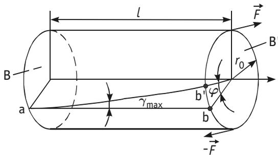
Bild 1 Torsionsstab
